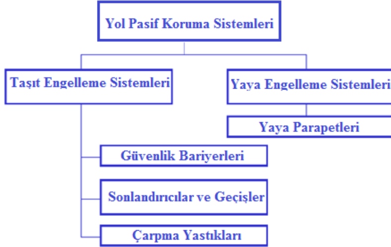
Şekil 76: Yol pasif koruma sistemlerinin sınıflandırılması [A.13]
