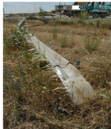
Şekil 14: Sonlandırıcının ilk birkaç dikmesine çarpılmasının sonuçları
