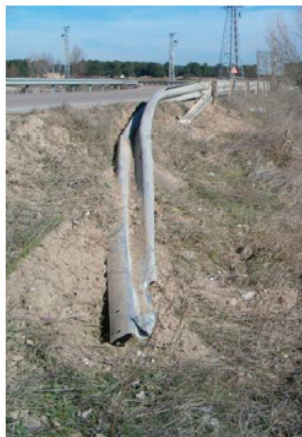
Şekil 14: Sonlandırıcının ilk birkaç dikmesine çarpılmasının sonuçları
