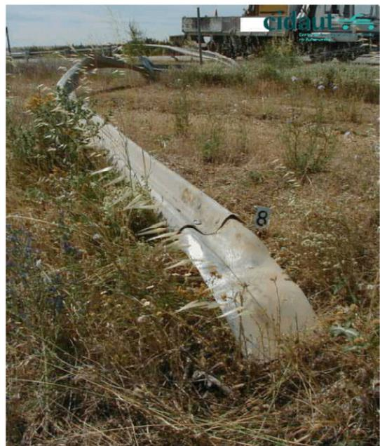
Figure 14 : Résultat d'un impact sur les premiers poteaux d'une extrémité [1] **11**
