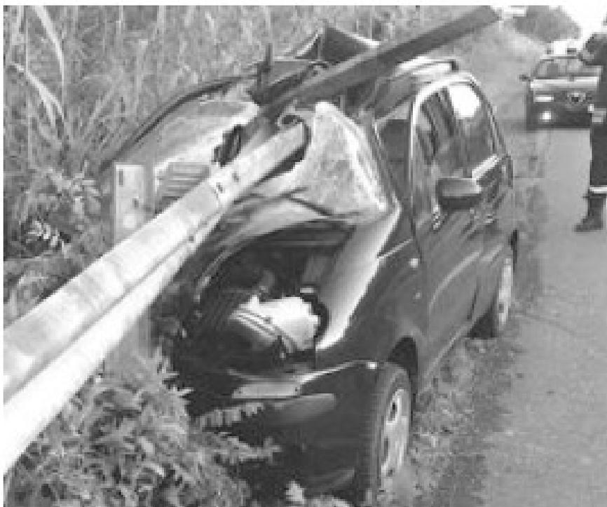
Figure 3: Collision frontale avec une extrémité de glissière non protégée [8][8]
