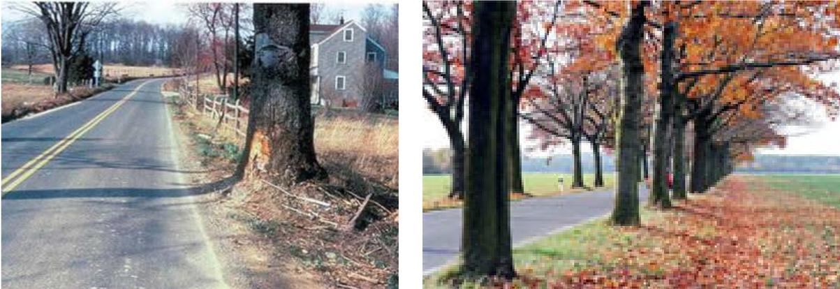
Figure 49 : Exemples d'arbres présentant un danger le long de la route (Source : [A.24], [A.53][A.24][A.53])
