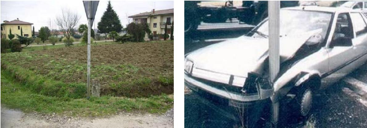
Figure 51 : Exemples de panneaux de signalisation dangereux (Source: [A.3][A.3])
