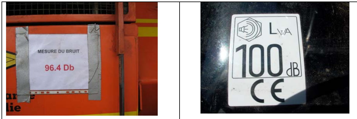
Figure 9.3 : Exemples de marquage du bruit sur du machinisme de production
