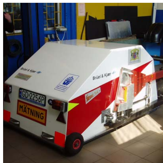
Figure 7.3 : Des remorques de mesure CPX du bruit peuvent être utilisées pour surveiller le bruit sur les revêtements neufs. Sur la gauche, une remorque découverte CPX mesurant en décibels A, appartenant à la Direction des routes danoises / l'Institut des routes danoises et, à droite, une remorque capotée CPX provenant de l'Université technique de Gdansk en Pologne.
