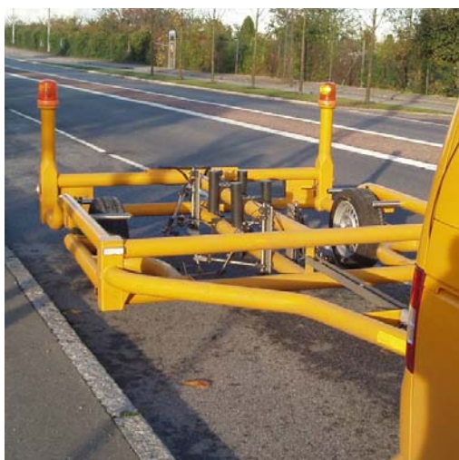
Figure 7.3 : Des remorques de mesure CPX du bruit peuvent être utilisées pour surveiller le bruit sur les revêtements neufs. Sur la gauche, une remorque découverte CPX mesurant en décibels A, appartenant à la Direction des routes danoises / l'Institut des routes danoises et, à droite, une remorque capotée CPX provenant de l'Université technique de Gdansk en Pologne.
