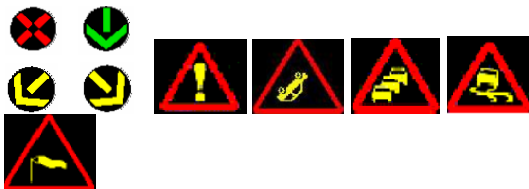
Fig. 4 : pictogrammes que FIVE avait recommandé d'utiliser sur les PMV ( les flèches affectées aux voies ont été considérées comme faisant partie du jeu utilisable sur des PMV)
