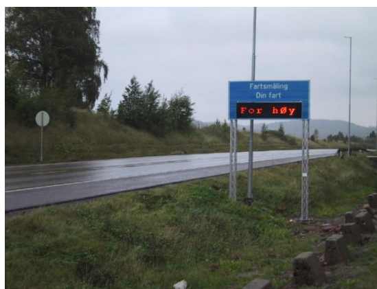
Fig. 19 : PMV norvégien prévenant les conducteurs que leur vitesse est excessive (Fartsmåling = mesure de la vitesse ; Din fart = votre vitesse ; For høy = excessive)
