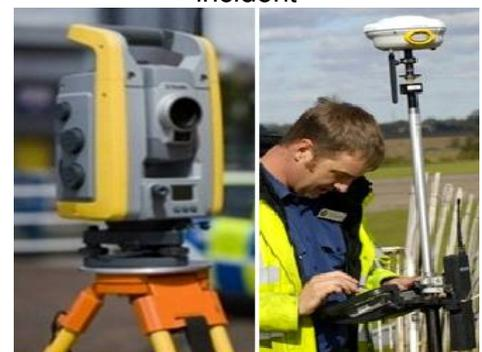
Fig. 16 : Scanner au laser & Récepteur GNSS
