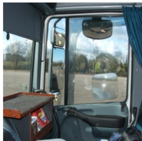
Fig. 19 : Lentille de Fresnel sur une vitre de cabine de poids lourd
