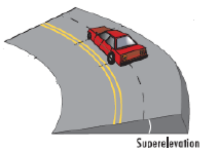
Figure 3.4. Surélévation ou dévers de courbe horizontale (AIPCR 2003)
